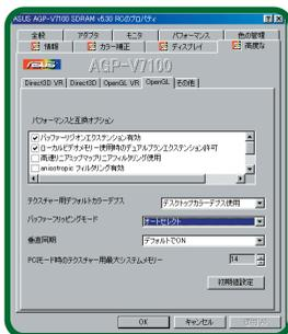
画面2 OpenGL設定。ベースはDetonator2のようだが、OpenGLに関しては別途にオンスクリーン設定などをサポートしている
