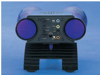
背面部。音声入力端子は光デジタルとアナログ音声の2系統。音量調整や音場プログラムの選択は背面スイッチで行うので、操作性はちょっとよくない。また、ヘッドホン出力に対応していないのも残念だ
