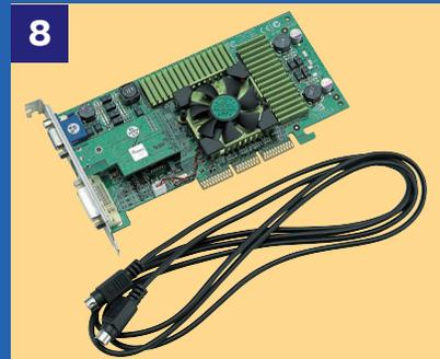
玄人志向ブランドから発売されたGF3-AGP64は、GAINWARD製のGeForce3搭載ビデオカードのOEM製品であり、基板色や仕様はCARDExpert GeForce3 PowerPack!!!と同じである。基板のデザインは、NVIDIAのリファレンスボードに準拠したもので、GeForce3にはファン付きのヒートシンクが装着されており、メモリ上にもヒートシンクがある。玄人志向ブランドの製品は、サポートなしのキワモノシリーズと1年間の製品保証が付くセレクトシリーズに分けられるが、GF3-AGP64はセレクトシリーズの製品なので安心だ。なお、今回試用したカードは、ビデオ出力チップのフィリップス SAA7108Eを実装したサブボードとDVI出力端子を装備したサンプル版だが、製品ではこれらの機能は省かれており、出力端子はVGA端子とS端子のみとなっている。
