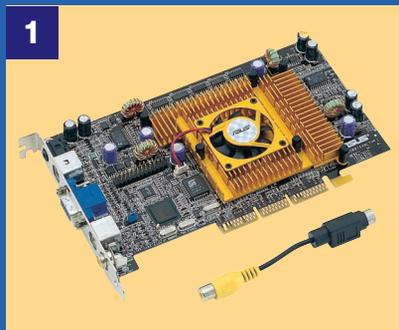
AGP-V8200 GeForce3 Deluxeは、ビデオキャプチャー機能を搭載し、液晶シャッター式3Dグラスが付属するなど豪華な仕様である。ビデオチップにはファン付きのヒートシンクが装着され、ビデオメモリにもヒートシンクが装着されている。独自設計の基板なのでパーツの配置はリファレンスボードとかなり異なる。ビデオ入出力チップとしてはフィリップス製SAA7108を採用し、VGA端子とS出力端子、コンポジット出力端子、S入力端子、3Dグラス接続用端子の合計五つの端子を備えている。また、ハードウェアモニター機能をサポートし、モニターツールの「SmartDoctor」によって、ビデオチップやビデオメモリの温度、ファンの回転数、電圧などを監視できる。
