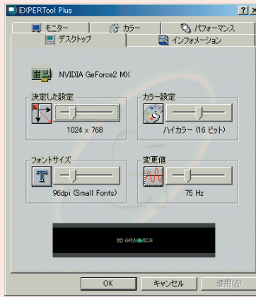
デスクトップ設定では解像度, 色数に加え, フォントサイズ, リフレッシュレートもまとめて変更可能
