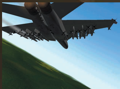
見よ、この重武装を！最新のスーパーホーネットはハードポイント(兵器取り付け部)が左右1か所増えている
